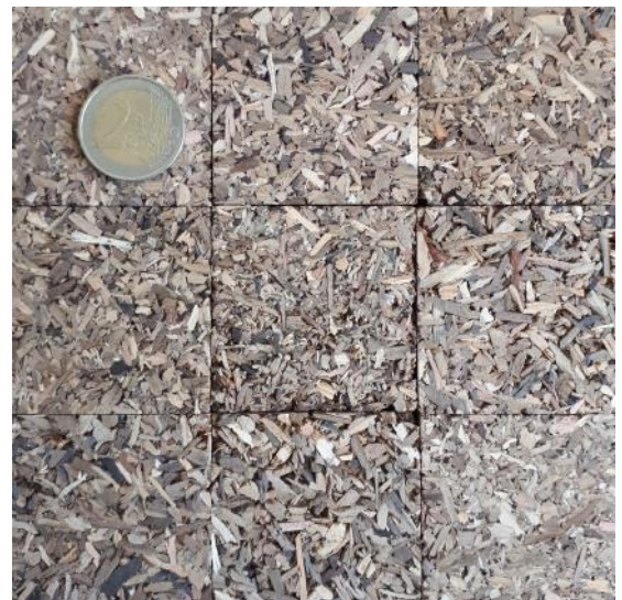
Abbildung 2: Spanplatten aus Kompost-Siebüberlauf (ohne Deckschicht).
